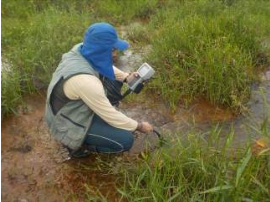
Figura 2: Uso do oxímetro para medir a concentração de oxigênio dissolvido na água, parte do procedimento padrão de análise de qualidade da água.
