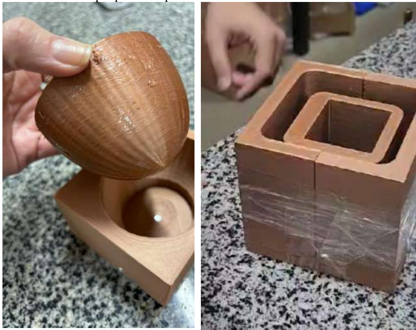
Figura 6: moldes impressos em impressora 3D em PLA dourado, sendo preparados para receber a biocerâmica
